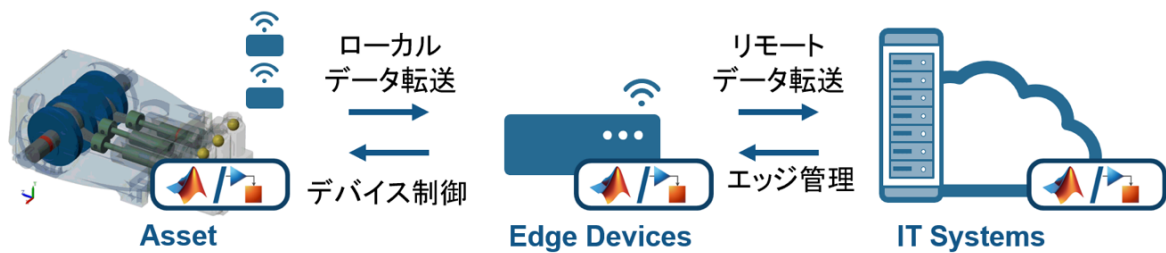
図 8 アルゴリズムの実装先もデータ転送量、計算量、運用方法によってデバイス上、エッジ上、クラウド上など様々な選択肢が存在する。
