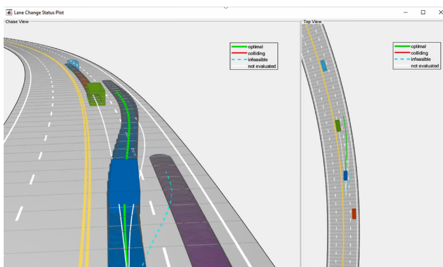
図3. ローカル・パスプランニング (青色直方体が自車、緑線が選択された経路)
